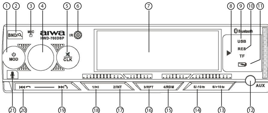
1. **⊕/MODE** Кнопка включения/выключения прибора/кнопка выбора режима работы прибора
